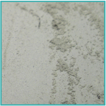
Cuando se raya con un objeto metálico, el hormigón no densificado se desgasta y se pulveriza fácilmente. El hormigón densificado y pulido ayuda contra la erosión y el desgaste, pero no puede evitarlos por completo.
